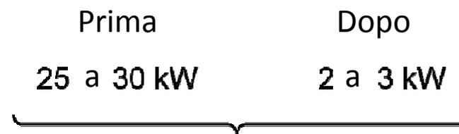
Campo di modulazione dell'impianto di riscaldamento
